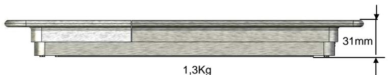
Spécialement étudié, le revêtement de la sole a pour objet d'assurer d'une part une isolation thermique et galvanique, et de permettre d'autre part, grâce à des marquages sérigraphiés, un placement correct des pieds du patient selon sa pointure.
